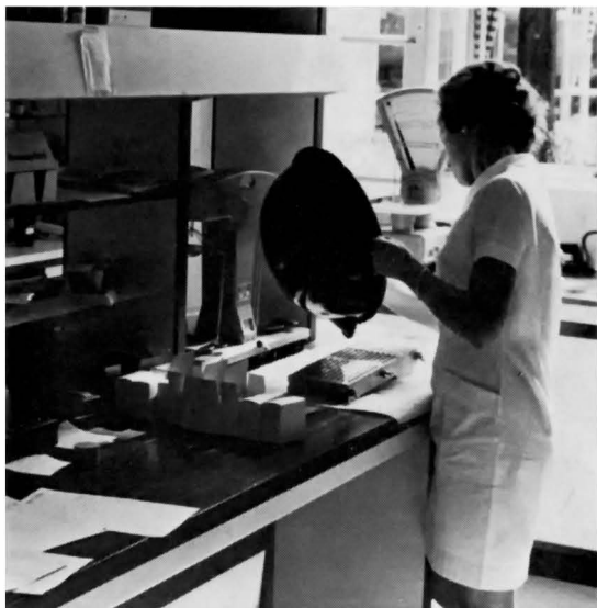
Het uitgieten van de gesmolten zetbilmasa in een vorm, waardoor 200 zetpillen tegelijk worden gemaakt.
